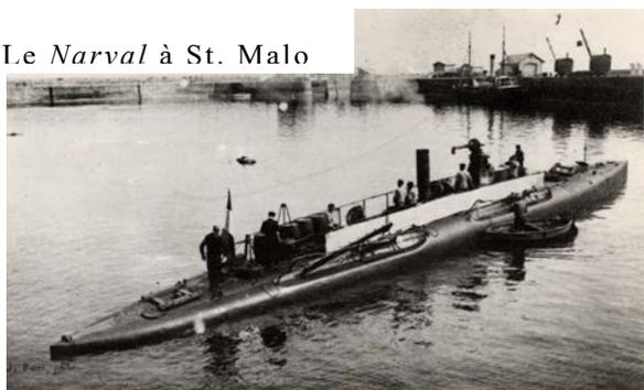
En 1898, l'ingénieur du Génie Maritime Maxime Laubœuf fait construire le 1<sup>er</sup> submersible le *Narval*, les water-ballasts annulaires étaient disposés entre la coque épaisse en forme de cigare et la coque mince extérieure ayant la forme des torpilleurs de l'époque. Il ne pouvait en rien se comparer avec les sous-marins à coque unique, il obtient la faveur de la Marine. C'est le premier sous-marin équipé d'une propulsion mixte : machine à vapeur en
